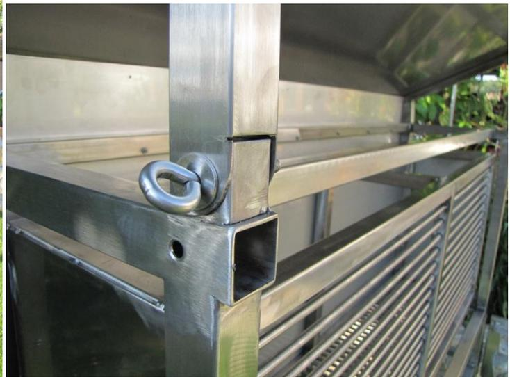
Dadurch lässt das Dach um 90 Grad nach vorne klappen wenn Kohle nachgefüllt werden soll:
